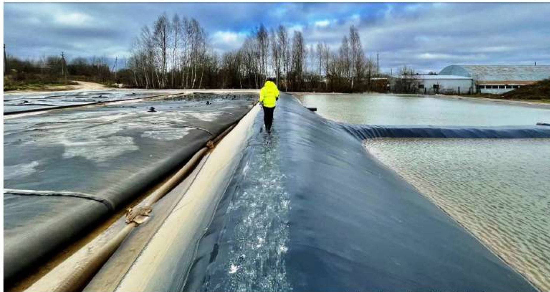
11 pav. Grunto nuvandeninimo aikštelė (dešinėje grunto sausavimo konteineriai, dešinėje vandens nusėdimo, nuskaidrėjimo baseinai).
